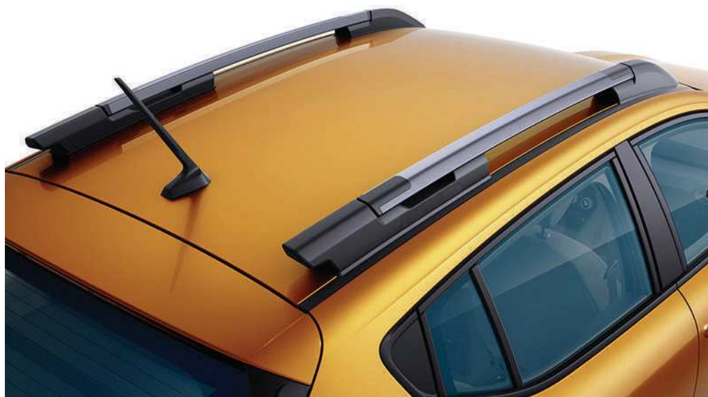
BARE DE PAVILION LONGITUDINALE
